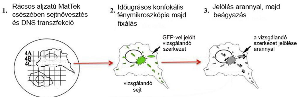
V.3. ábra. MatTek csésze alkalmazása fény- és elektronmikroszkópos vizsgálat közötti korreláció meghatározására (lásd a szöveget) (POLISHCHUK 2012)
