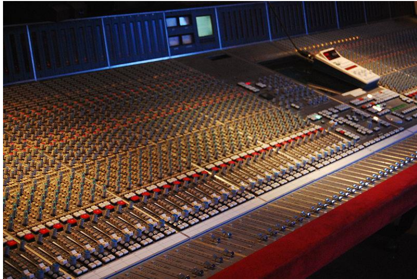
10.9. ábra: 1+2 és 72 csatornás keverőasztal
