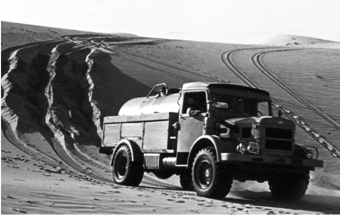
11. kép Csepel D 346 típusú összkerekhajtású sivatagi jármű 3,5-4 tonna hasznos terhelésre. 1971-ben egyiptomi sivatagi próbák.
