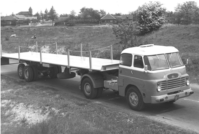
14. kép Csepel D 705.40-0.72.08 típusú nyerges szerelvény 20 tonna hasznos terhelésre, hosszú anyag, cső szállítására. Kuvait számára sivatagi olajvezetékek fektetéséhez, 1967–1968. A leghosszabb, kb. 17 méteres Csepel jármű.
