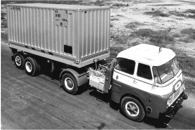
15. kép Csepel D 705.40-0.72.06 típusú nyerges szerelvény 20 tonna hasznos terhelésre, konténer szállítására.
