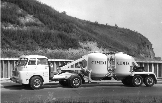
13. kép Csepel D 705.35-0.71 típusú nyerges szerelvény 15 tonna cement szállítására. A legnagyobb összgördülő tömegű 28,5 tonnás Csepel jármű.
