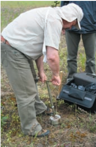
7.13. fotó. Talajmintavétel az akkreditált terepi mérőhelyen
