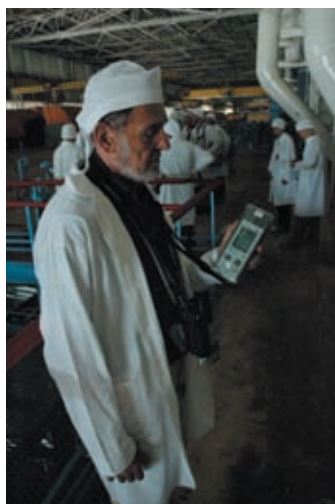
7.2. fotó. Nagy pontosságú dózisteljesítmény-mérők alkalmazása a terepen és az erőműben
