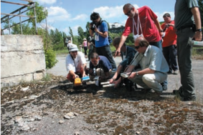
7.11.a. fotó. Műszerek összemérése Pripjatyban egy mohatelep fölött
