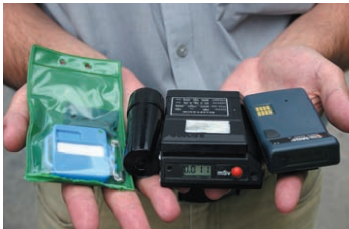
7.1. fotó. A személyi dozimetria eszközei (balról jobbra: hatósági film- és termolumineszcens doziméter egy műanyag tokba csomagolva; űrdozimetriai TLD; ALNOR- és MGP-típusú elektronikus személyi doziméter)
