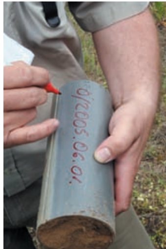
7.13. fotó. Talajmintavétel az akkreditált terepi mérőhelyen
