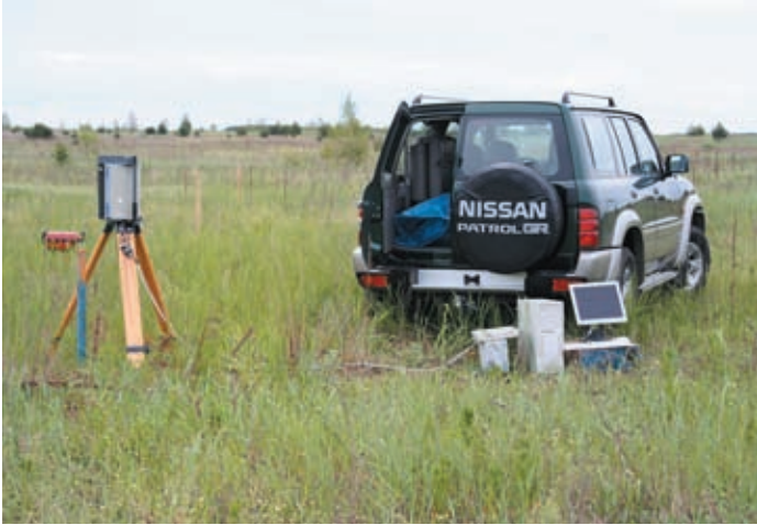
7.12. fotó. In-situ \gamma -spektrometriás mérés és dózisteljesítmény-mérés az akkreditált terepi mérőhelyen
