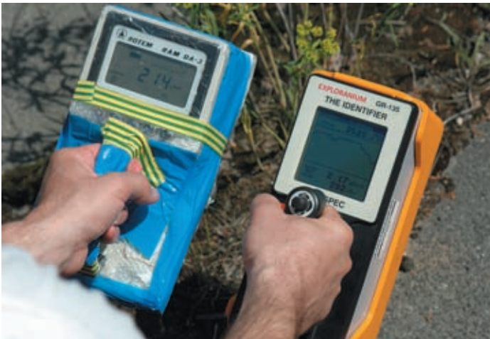
7.11.b. fotó. Műszerek összemérése Pripjatyban egy mohatelep fölött (A mutatott dózisintenzitás 2,14-2,17 \mu\text{Sv/h} , a budapesti referenciaérték 22-szerese)
