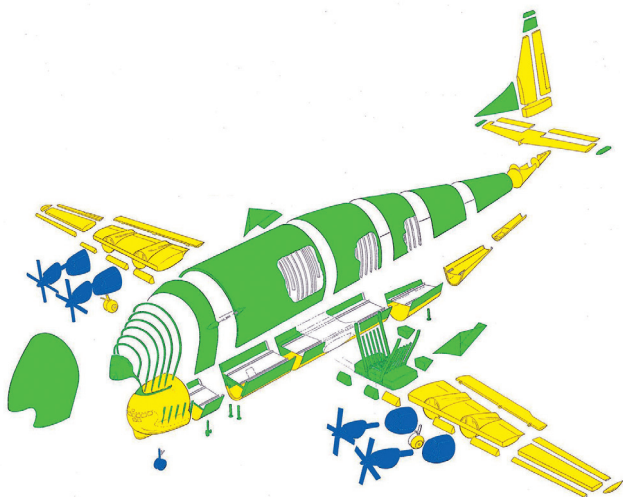
A Super Guppy átalakulása (Sárga: Eredeti Boeing 377 részegységek ; Zöld: Átalakításkor készített új elemek ; Kék: Más típusú gépekről átvett részek)
