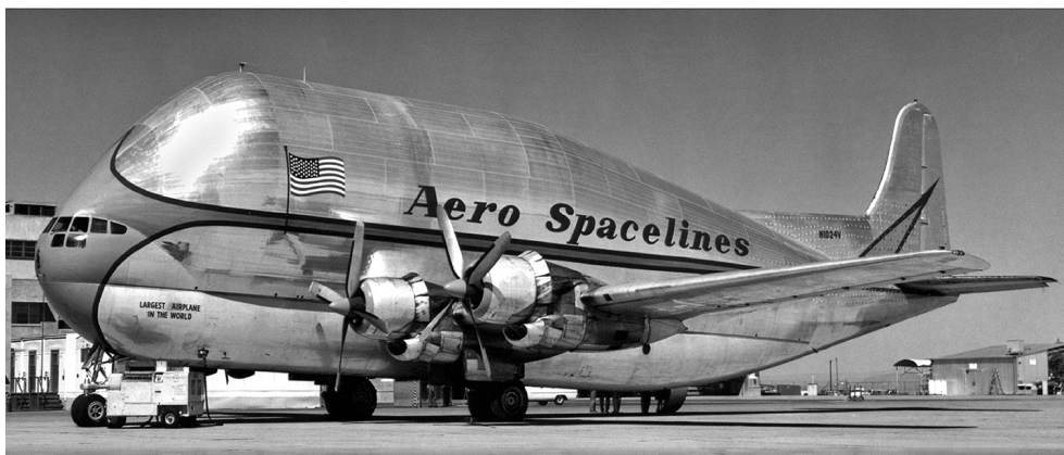
A Pregnant Guppy szállítógép kialakulásának folyamata az eredeti B-29-es „Superfortress” bombázótól a Boeing 377-es „Stratocruiser” nagy hatótávolságú luxus utasszállítón át
