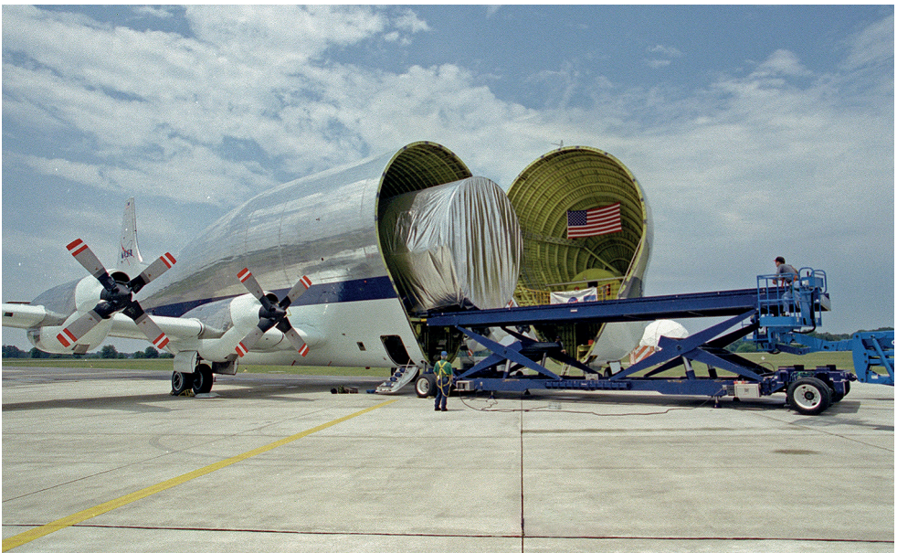
Egy hagyományos repülőgép törzsét rakodják speciális berendezéssel a Super Guppyba
