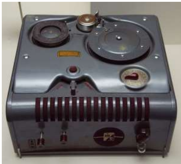
6.3. ábra: Fémdróton rögzítő magnetofon (Webster-Chicago 228-1, 1951)
