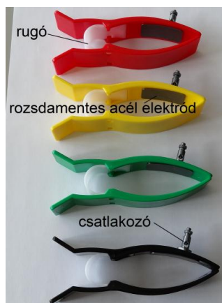
1.14. ábra. EKG-végtagelektrodok. A színekódolás: piros: jobb kéz, sárga: bal kéz, zöld: bal láb, fekete: jobb láb.
