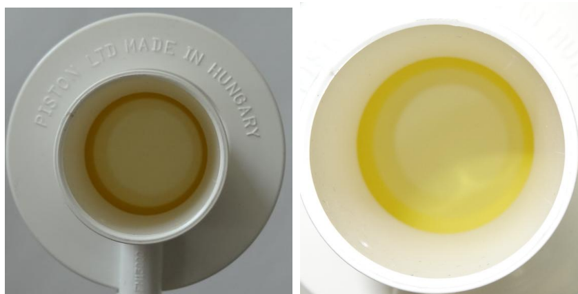
9.5. ábra. Fátolszövettel megvalósított áramlási ellenállás
