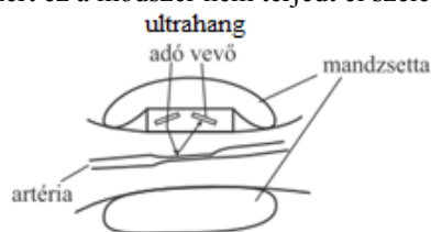
8.7. ábra. Az érfalelmozdulás ultrahangos detektálása a mandzsetta által körülvevett érszakaszon
