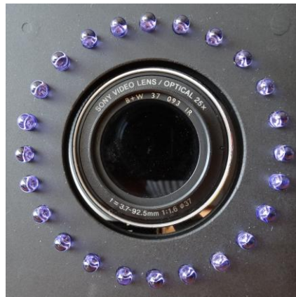
10.22. ábra. A PAM kamera IR szűrővel és IR LED gyűrűvel
