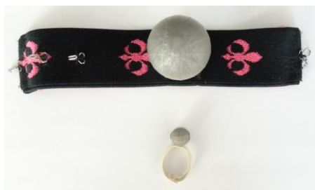
10.8. ábra. Csuklóra (felül) és ujra (alul) gumiszalaggal rögzíthető passzív markerek
