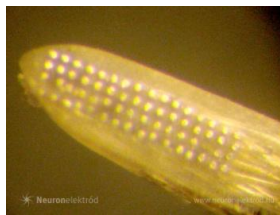
1.19. ábra. Agy közvetlen vizsgálatára alkalmas mátrixelrendezésű elektród (Neuronelektrod Kft.) http://www.neuronelektrod.hu/getpage.php?oldal_id=351
