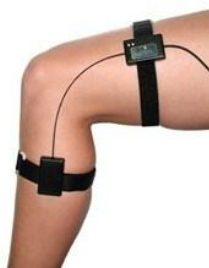
10.3. ábra. Térdre helyezett goniométer http://www.adinstruments.com/products/mlts700#overview (Az ADInstruments cég terméke.)
