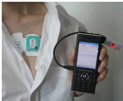
6.40. ábra. Vezeték nélküli EKG-monitor ( http://commons.wikimedia.org/wiki/File:Wireless_ECG_Monitor.jpg szerző: かつぱー)
