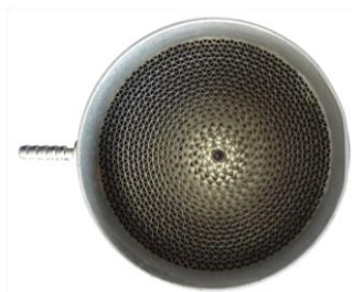
9.3. ábra. A Fleisch-cső áramlási ellenállásának fényképe
